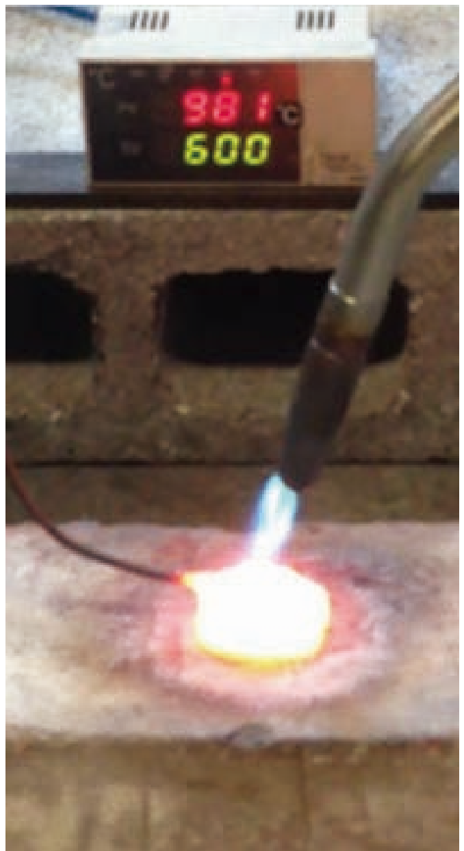
図3：マグネシウム合金の燃焼試験
