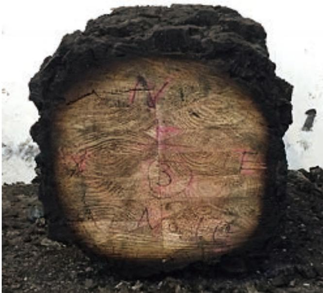
写真2：火災実験後の柱の切断面
