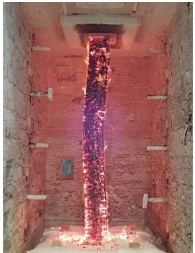
写真1：火災加熱を受けたスギ柱が座屈破壊した様子
