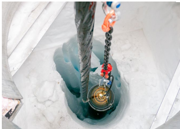
図 3 D-Egg がケーブルにつながれ掘削孔に入っていく様子 (photo: Aya Ishihara/IceHap)
